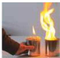
El recipiente con protegido con Explostop (izquierda) alcanza alrededor de los 55°, pudiéndose tocar sin riesgo a quemarse, frente a los más de 150 grados del recipiente sin proteger
